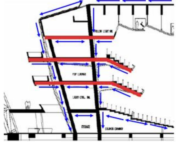
اسكتش يوضح الحواط الخرسانية الحاملة للقاعة بالإضافة الى بعض الحوائط الصغيرة التى تعمل على تثبيت بعض المقاعد
